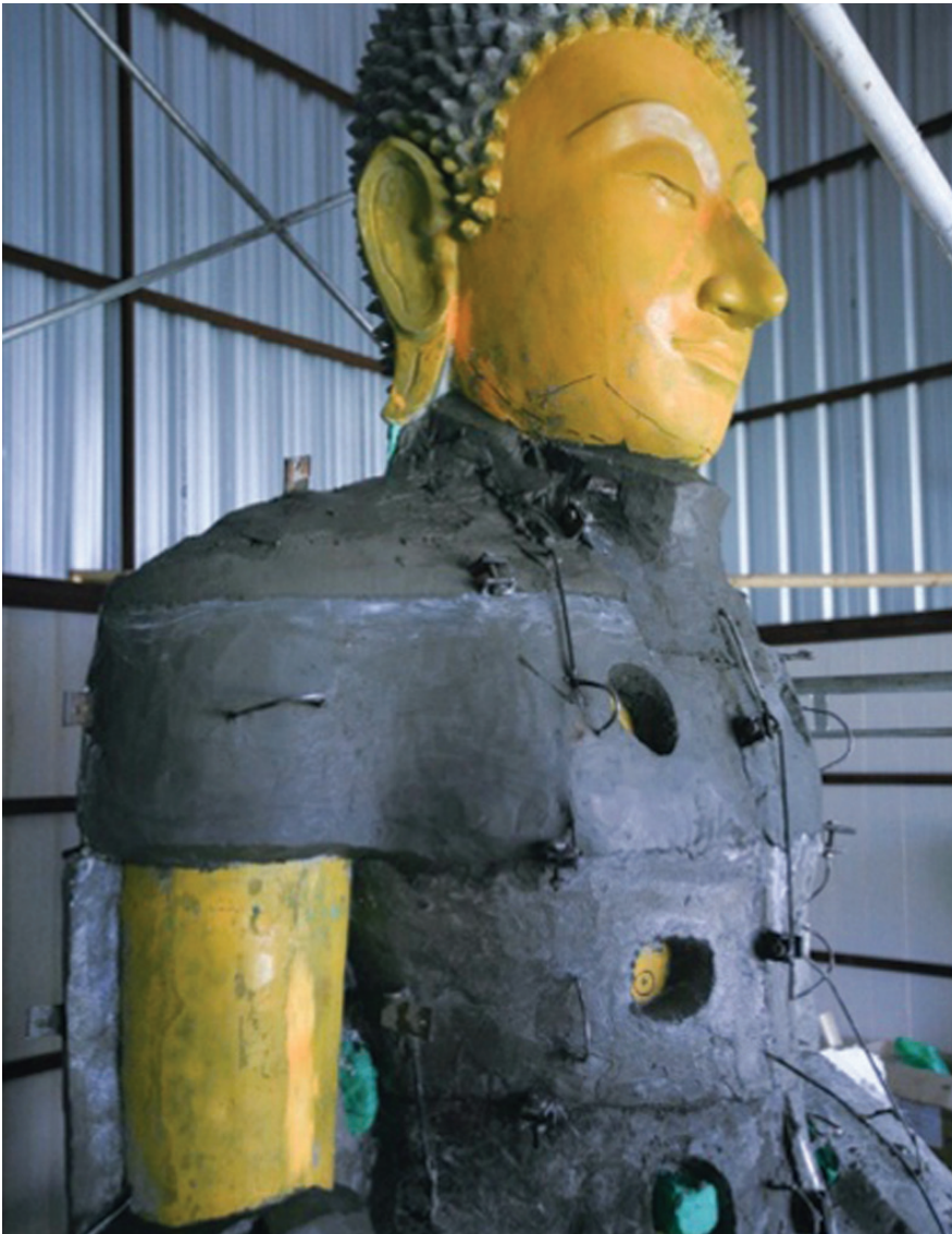
คณะช่างได้ทำการหล่อเปลือกกับพระองค์แสนจำลอง ณ โรงหล่อชั่วคราว ภาพ : สำนักงานโยธาธิการและผังเมืองจังหวัดสกลนคร
