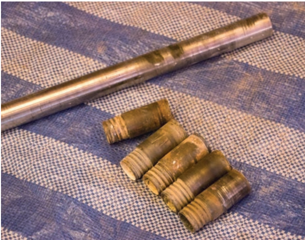
หัวส่วนที่ใช้เจาะและก้านเจาะ ต้องใช้หลายหัวสับเปลี่ยนกัน ภาพ : สำนักงานโยธาธิการและผังเมืองจังหวัดสกลนคร
