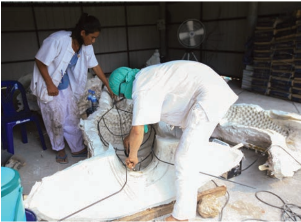
คณะช่างนำพิมพ์ยางซิลิโคน ๑๑ ชั้นมาเสริมโครงหลักสำหรับหล่อพระองค์แสนจำลอง ณ โรงหล่อชั่วคราว ภาพ : สำนักงานโยธาธิการและผังเมืองจังหวัดสกลนคร
