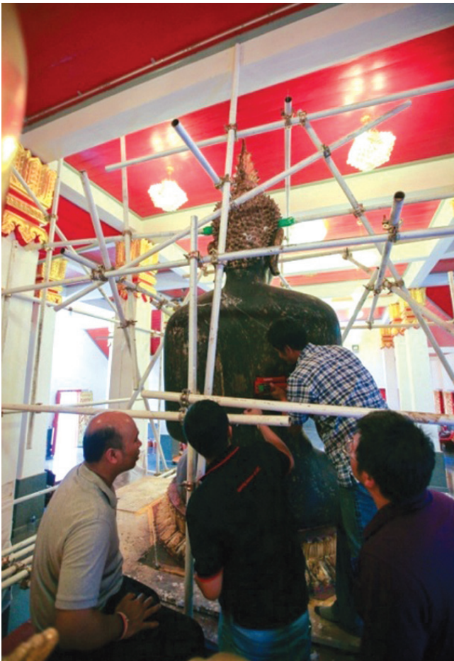
แนวตำแหน่งเหล็กภายในพระองค์แสนที่คณะตรวจสอบสแกนพระองค์แสน จากมหาวิทยาลัยเกษตรศาสตร์ วิทยาเขตเฉลิมพระเกียรติ จังหวัดสกลนคร ได้เข้าตรวจสอบสแกนด้วยเครื่อง Ferro scan ภาพ : สำนักงานโยธาธิการและผังเมืองจังหวัดสกลนคร
