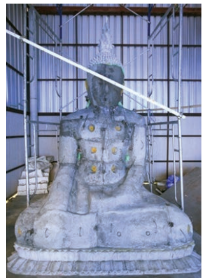
คณะช่างได้ทำการหล่อเปลือกกับพระองค์แสนจำลอง ณ โรงหล่อชั่วคราว ภาพ : สำนักงานโยธาธิการและผังเมืองจังหวัดสกลนคร
